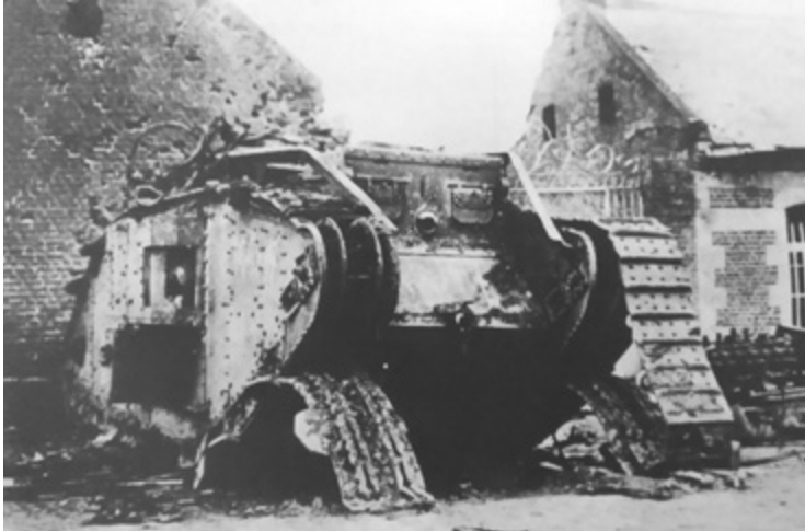
Pian osoittautui, että uudet panssarivaunut olivat alttiita jo olemassa olleille aseille, kuten kenttätykeille. Ensimmäisten panssarivaunujen panssari ei kestänyt edes sopivassa kulmassa ammuttua kiväärin panssariluotia. Bundesarchiv, Bild 183-R27012 / CC-BY-SA, CC BY-SA 3.0 de, https://commons.wikimedia.org/w/index.php?curid=5368361 .
